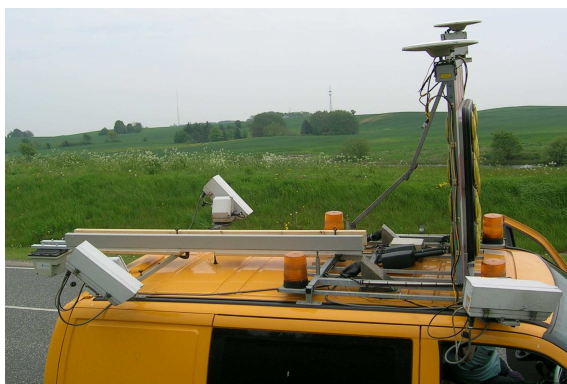
Figur 4.3 – Konstruktionen på taget af DyRoS, som den ser ud. Dog er afstiveren ikke låst.
