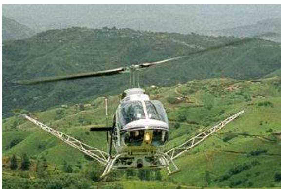
Figur 2.1 – Helikopter med FLI-MAP ® systemet [FLI-MAP, 2005].
