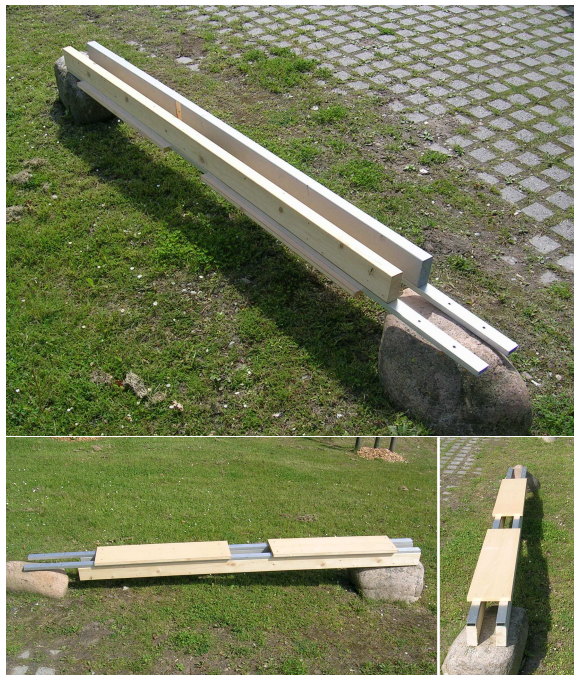
Figur 6.2 – Konstruktionen lavet til montering af laserskanneren på DyRoS bilen.
