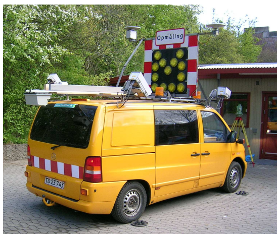
Figur 6.1 – Billederne viser DyRoS bilen med den eksisterende konstruktion af platformen til positionerings- og orienteringsinstrumenterne. Samt den samlede konstruktion med laserskanneren implementeret.
