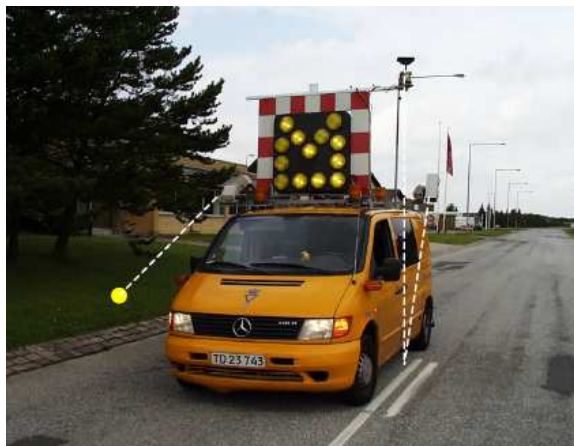
Figur 2.5 – Vejdirektoratets DyRoS bil til kørende rational opmåling af vejlinier [Vejdirektoratet, 2005].
