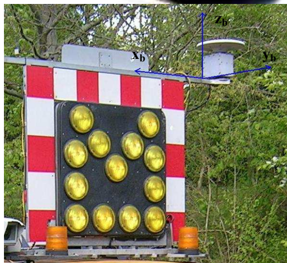
Figur 6.3 – Body koordinatsystemets retninger på DyRoS bilen, samt drejningerne ift. navigationskoordinatsystemet.
